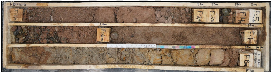
Figura D-3: Perforación BH23-02 – Profundidad: 0m a 10m
