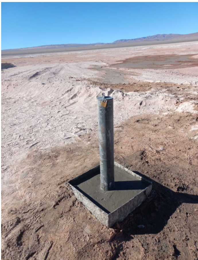
Figura 8-1: Tubo metálico de superficie y dado de hormigón de la perforación
