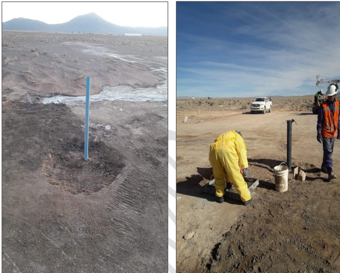
Figura 7-1: Imagen del tubo metálico de superficie y dado de hormigón
