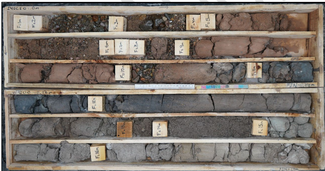
Figura D-9: Perforación BH23-07 – Profundidad: 0m a 17m
