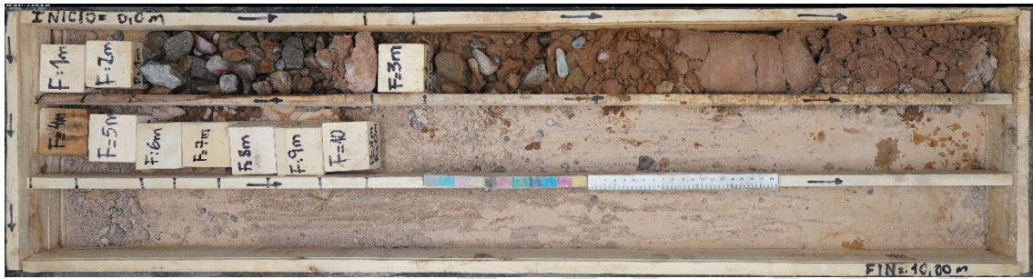
Figura D-8: Perforación BH23-06 – Profundidad: 0m a 10m
